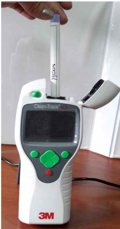
Fig. 2. Tórcula post hisopado introducida en Luminómetro, 3M™ Clean-Trace™ para su medición en URL.
