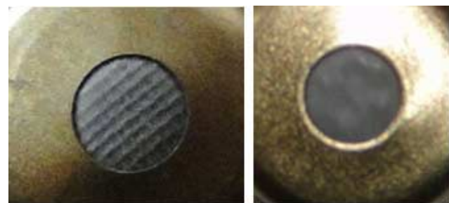
Fig. 4. Membrana semipermeable del tubo. Se observa un cambio en la consistencia y textura de superficie
